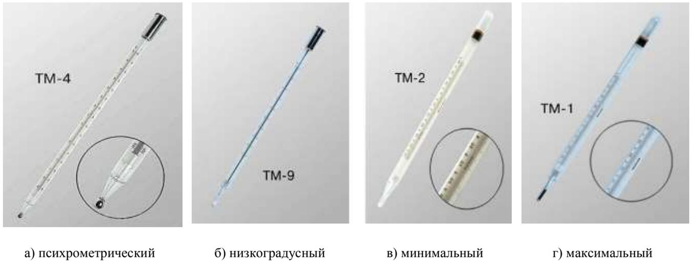
Рисунок 1- Термометры для измерения температуры воздуха
