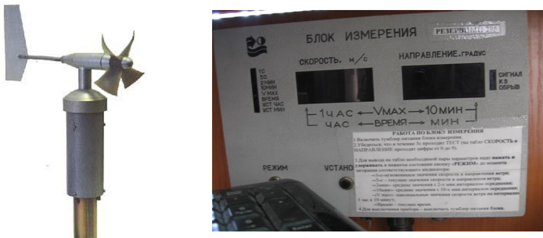
Рисунок 7 - Измеритель параметров ветра ИПВ-01-01. а) датчик; б) блок измерения
