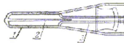
Рисунок 4.1 - Приспособление для сохранения максимальных показаний термометра.
