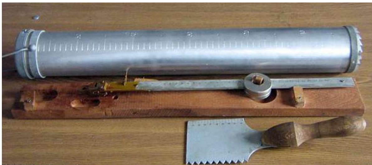
Рисунок 4 – Весовой снегомер ВС-43
